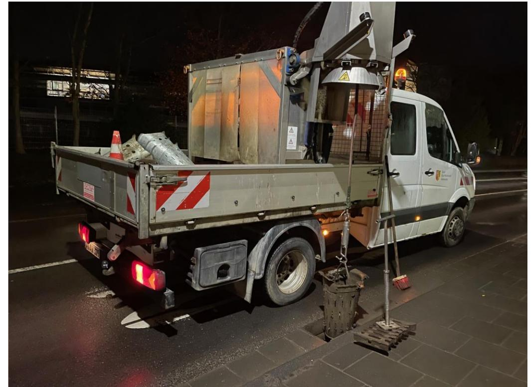
Für die regelmäßige Reinigung von Straßeneinläufen wurde ein **Sinkkasten-Reinigungsgerät** angeschafft.
