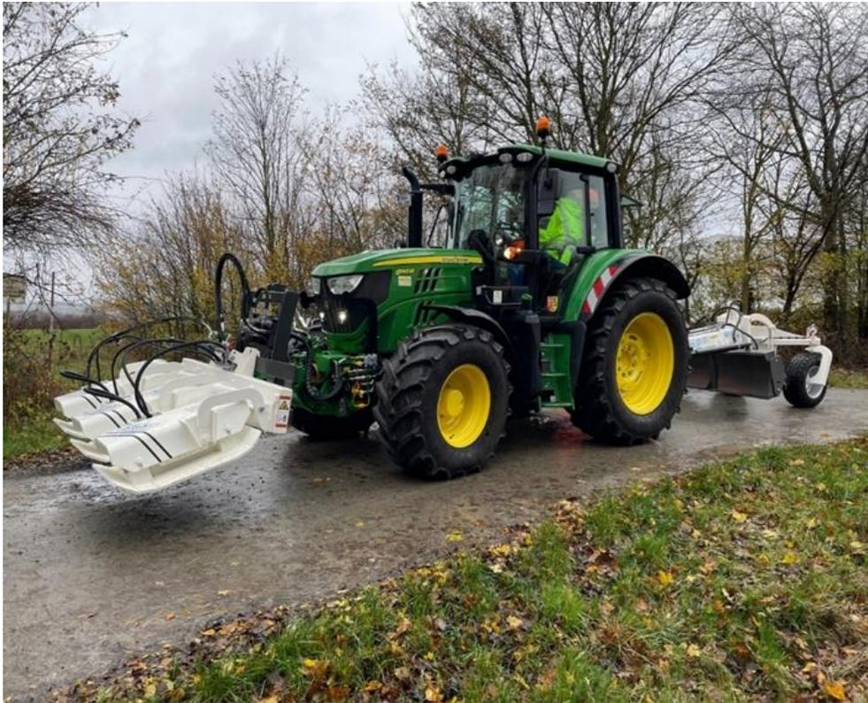
Anbaugrader und Plattenverdichter
