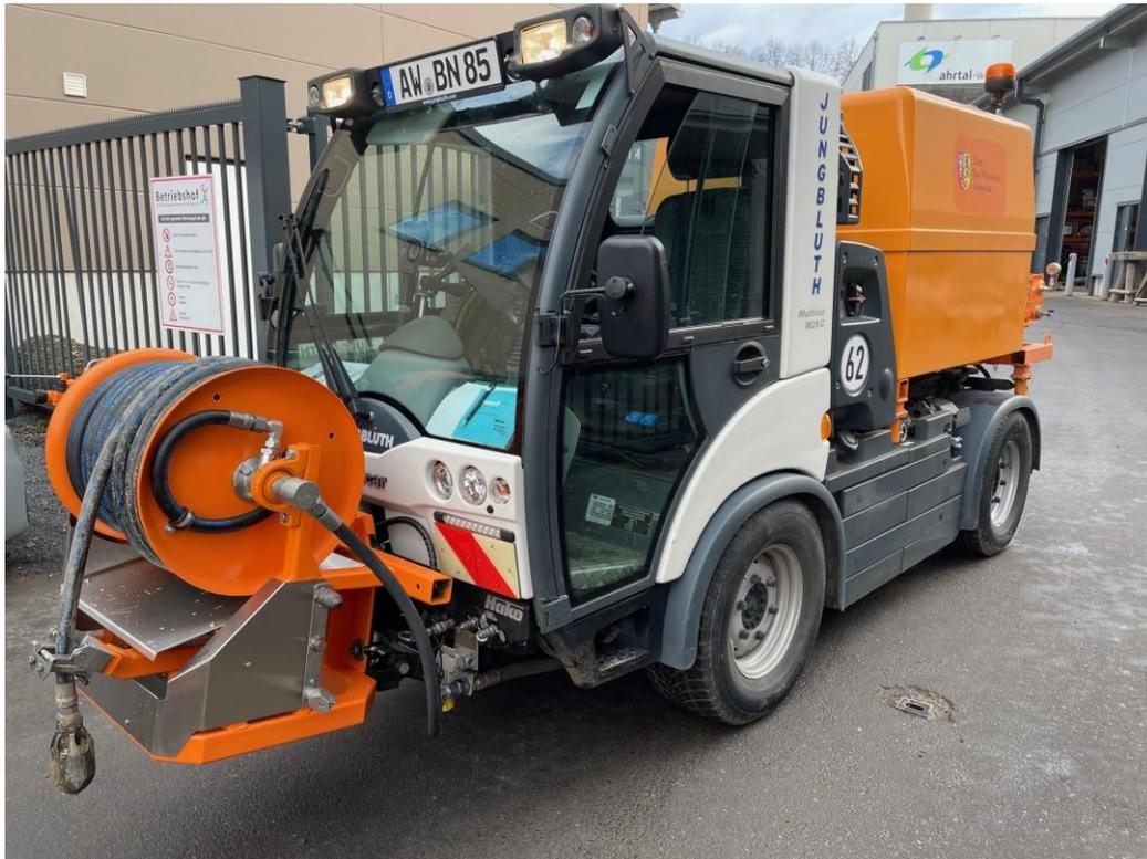
Für die regelmäßige Reinigung von Verrohrungen im Außenbereich wurde eine **Anbau-Hochdruck-Rohrreiniger** für ein vorhandenes Allradfahrzeug angeschafft.
